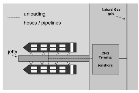
**Fig. 3.** Exemplary scheme of unloading CNG tanker at the jetty – own source **Rys. 3.** Przykładowy schemat rozładunku tankowców CNG przy nabrzeżu (pirsie) – opracowanie własne
