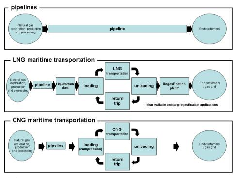
**Fig.2.** Schemes of different natural gas delivery possibilities (own source) **Rys. 2.** Schematy różnych możliwości dostaw gazu ziemnego (opracowanie własne)
