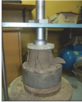
Rys. 2. Widok próbki w trakcie badania wytrzymałości na ściskanie (fot. E. Gałowicz)
