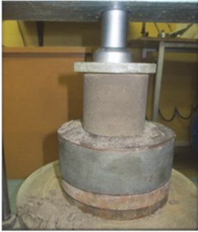
Rys. 2. Widok próbki w trakcie badania wytrzymałości na ściskanie (fot. E. Gałowicz)
