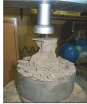
Rys. 2. Widok próbki w trakcie badania wytrzymałości na ściskanie (fot. E. Gałowicz)
