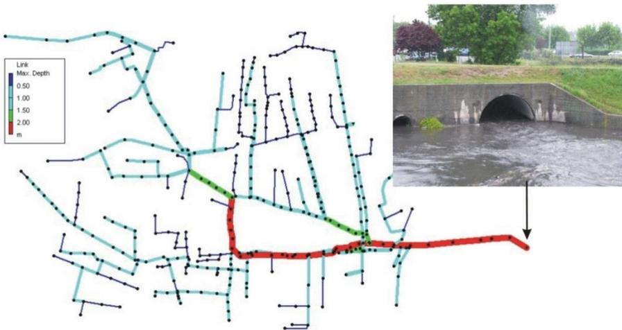
**Rys. 7.** Schemat sieci kanalizacji deszczowej dla przypadku B
