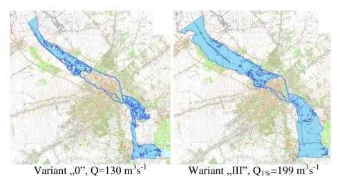
**Fig. 2.** Flood hazard zone for variant "0" and "III" **Rys. 2.** Zasięg zalewu dla wariantu "0" i "III"
